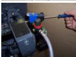
4. Отвинтить уплотнительный болт от магнитного вентиля
