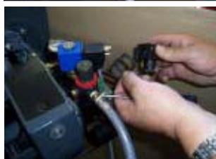
7. Штекер магнитного вентиля с уплотнителем вставить в штекер адаптера и закрепить
