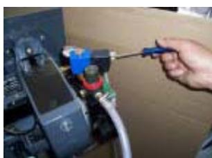
6. Присоединить штекер магнитного вентиля с уплотнителем от кабеля адаптера к катушке магнитного вентиля и закрепить
